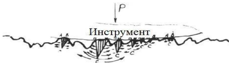
Рисунок 4. Качественная картина деформирования поверхности при ППД.
